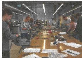
Bei der Anfertigung eines Schließzylinders werden die Metallstücke auch mit Säge und Feile bearbeitet.
